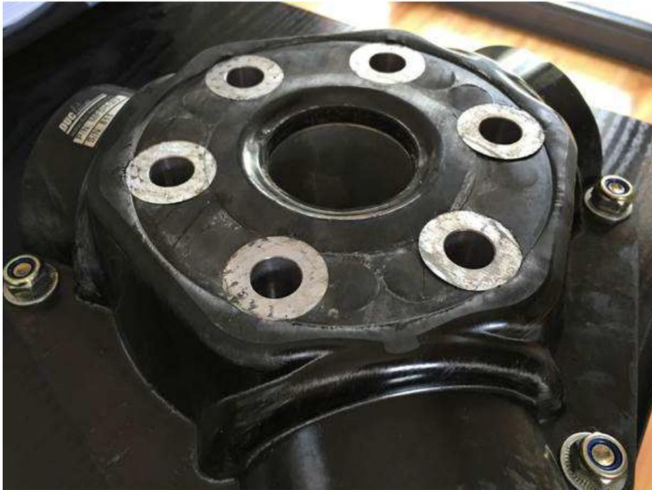
Flash-Back PV : il sera nécessaire de régler la longueur du tube de commande en carbone afin de prendre en compte l'épaisseur de la flasque (4 mm).
